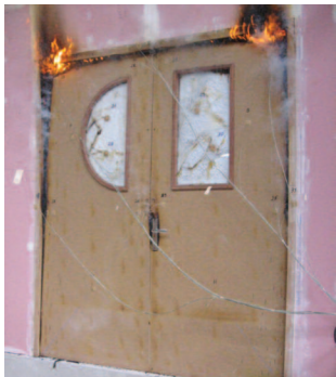
Le temps de résistance est dépassé. L'essai se termine. L'opérateur va relever les mesures et l'état de la porte.
