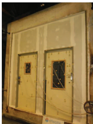
Mise en place de l'essai, selon NF EN 1634-1
