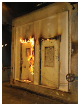
Durant l'essai : passage de flamme
