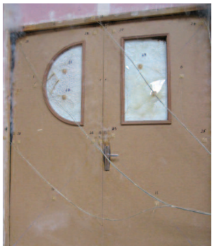
600° en un quart d'heure, 800° au bout d'une demi-heure, 1000° au bout d'une heure. Cette porte est au stade du temps de résistance recherché par le fabricant.
