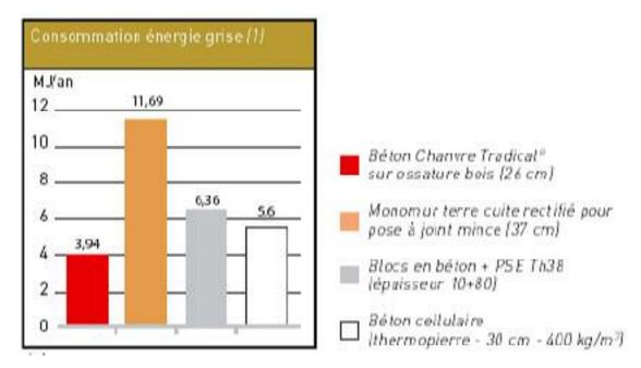
4 exemples d'énergies grises pour des constructions à transmission thermique équivalentes
